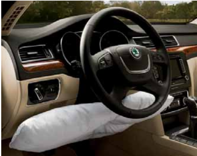
Knieairbag im Wagen Škoda Superb SP78_62
