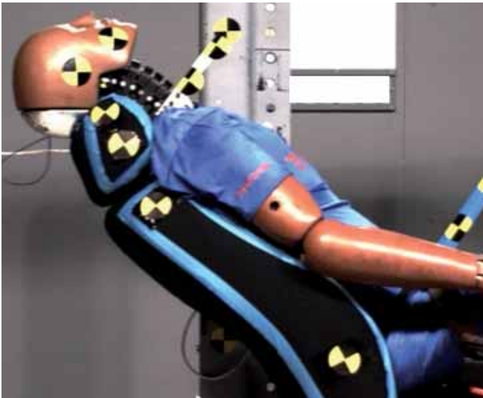
Zu niedrig eingestellte Stütze
