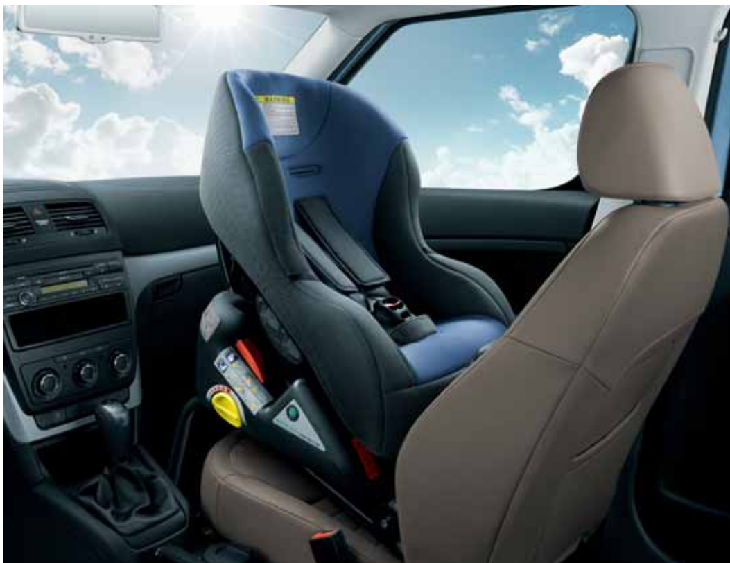
Kindersitz, befestigt mit dem System ISOFIX auf dem Vordersitz des Beifahrers im Wagen ŠkodaOctavia
