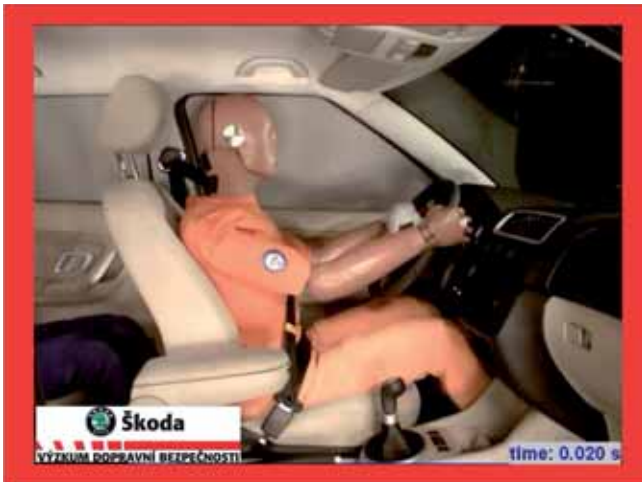
Kontakt mit einem Hindernis - Aktivierung der Gurtstraffer und des Airbags. SP78_28
