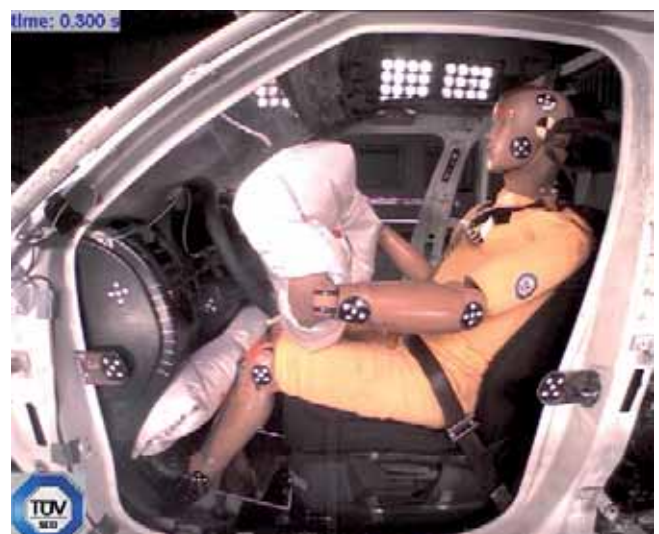
Status der Arretiersysteme und Testfiguren nach dem Test – das Lenkrad ist um 75 mm in Richtung des Motors verschoben.
