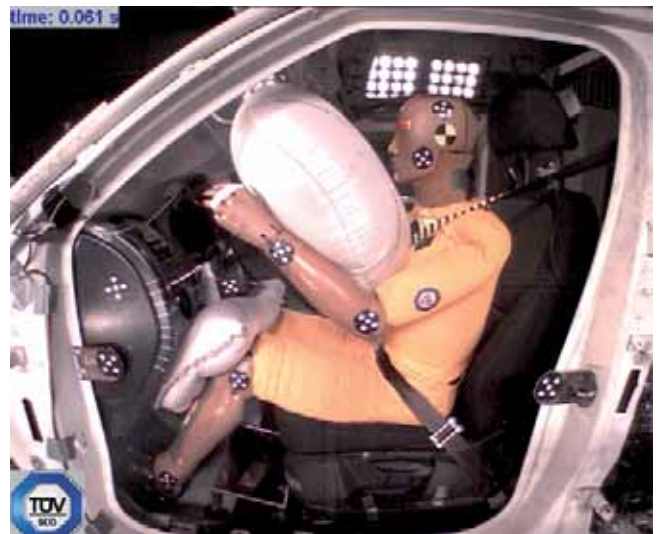
Status der Arretiersysteme vor dem Auftreffen der Testfigur auf die Airbags.
