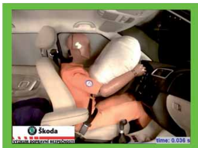
Der Airbag ist gefüllt, der Gurtkraftbegrenzer beginnt, den Gurt zu lockern.
