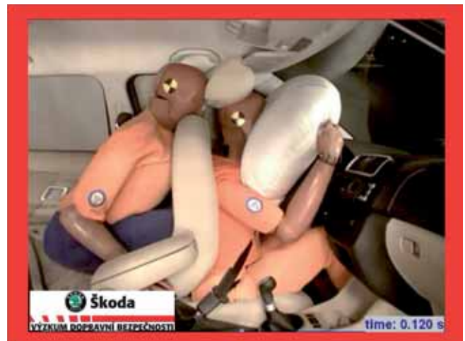
Kontakt des Brustkorbs und des Kopfes des Beifahrers mit der Lehne. SP78_31
