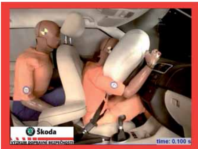
Maximales Einsinken in den Airbag, der Beifahrer stößt mit den Knien an die Lehne. SP78_30
