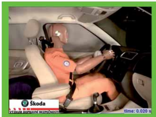
Aktivierung der Gurtstraffer und des Airbags. SP78_23
